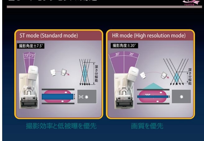
図5 トモシンセシスの原理
